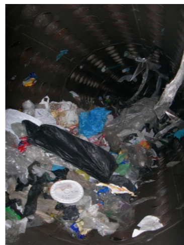
Foto 2 e 3: Separazione dei diversi tipi di plastica per colore mediante lettore ottico (a sinistra) e per dimensione mediante vaglio rotante (a destra)
