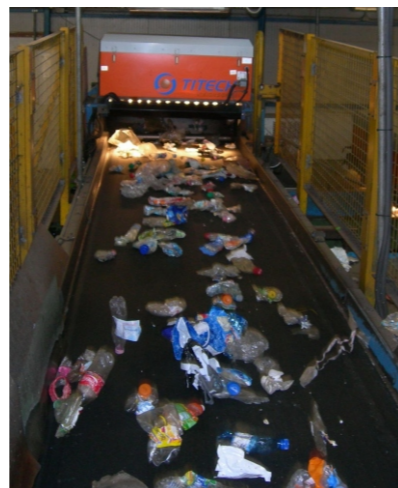
Foto 2 e 3: Separazione dei diversi tipi di plastica per colore mediante lettore ottico (a sinistra) e per dimensione mediante vaglio rotante (a destra)
