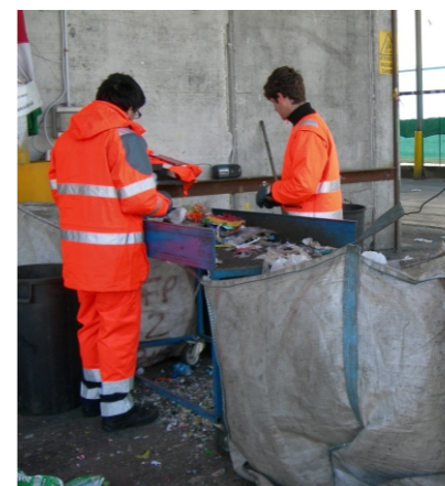
Foto 4 e 5: Analisi merceologica per il controllo della qualità del rifiuto in uscita dall'impianto (a sinistra) ed il cartellino di identificazione di una bolla di cassette di plastica (a destra).
